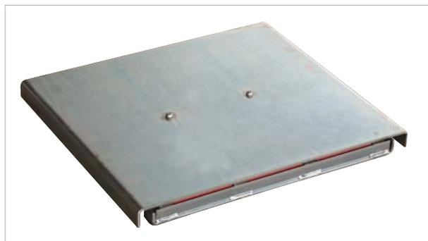
С его помощью можно быстро определить увод автомобиля. Это не требует дополнительных трудозатрат и времени, так как площадка устанавливается непосредственно перед тестером подвески или тормозным стендом, и автомобиль просто переезжает через неё. Диагностика увода выполняется автоматически. Результат представляется в диапазоне от 0 до  $\pm 20$  мм/м.
