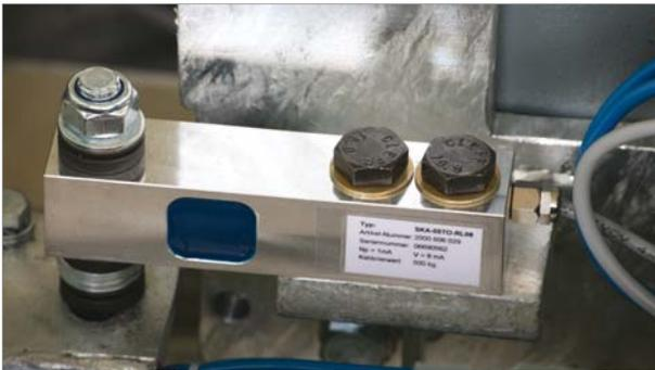
Измерение параметров выполняется тензометрическими датчиками. Эта безыносная техника обеспечивает надёжные и точные измерения силовых параметров.
