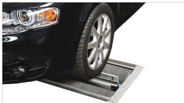
При поднятой балке автомобиль может легко въезжать на стенд и съезжать с него. Автомобили со спортивной подвеской, с малым клиренсом, с колесами малого радиуса легко устанавливаются на стенд без опасности повреждения днища. Внимание. Необходимо предусмотреть соответствующий фундамент, подвод воздуха 8 бар. Грузоподъёмность балки 3 т.
